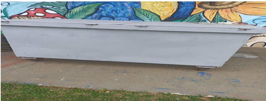
Figura 3: Contentor em processo de reforma, aplicado fundo antiferrugem.
