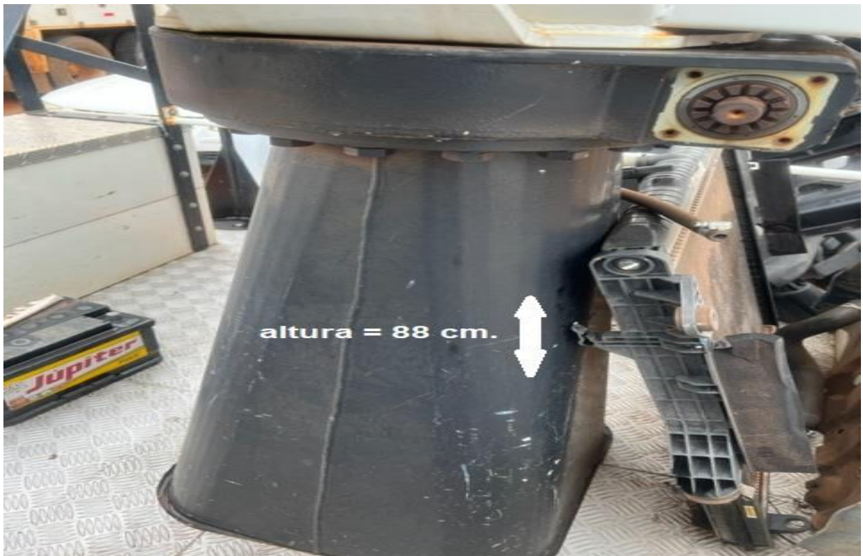
Figura 3: Detalhe da base do cesto aéreo.
